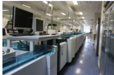
Roche Cobas 全自动样品处理系统
