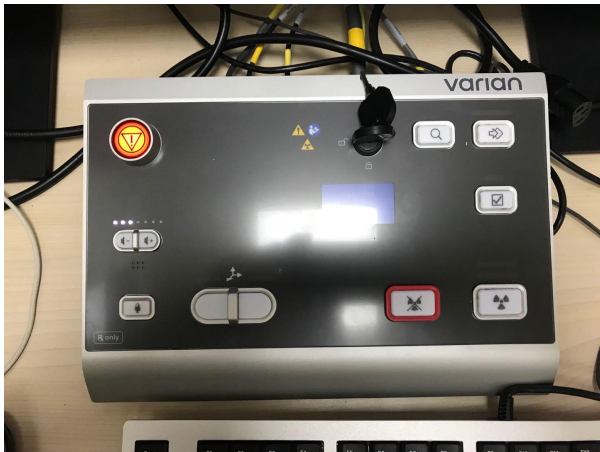
(钥匙开关、急停按钮和对讲装置)
